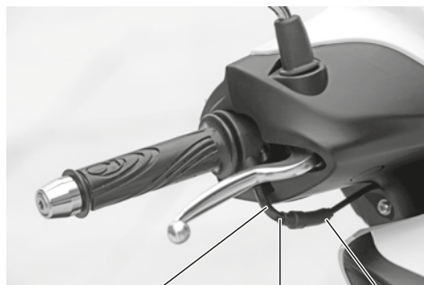
Controdado (3) Vite di regolazione (2) Manicotto in gomma (1)
